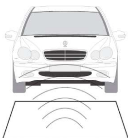
Lazo magnético de detección de vehículos
