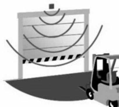
Radar de microondas
