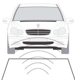
Lazo magnético de detección de vehículos
