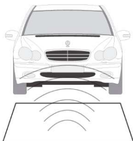
Lazo magnético de detección de vehículos
