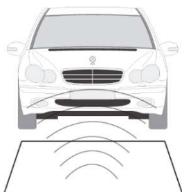
Lazo magnético de detección de vehículos
