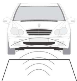
Lazo magnético de detección de vehículos
