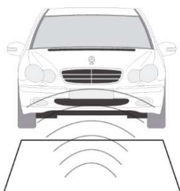
Lazo magnético de detección de vehículos
